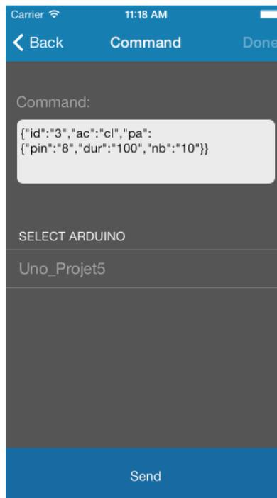
Figure 30 : vue d'envoi de commande JSON
